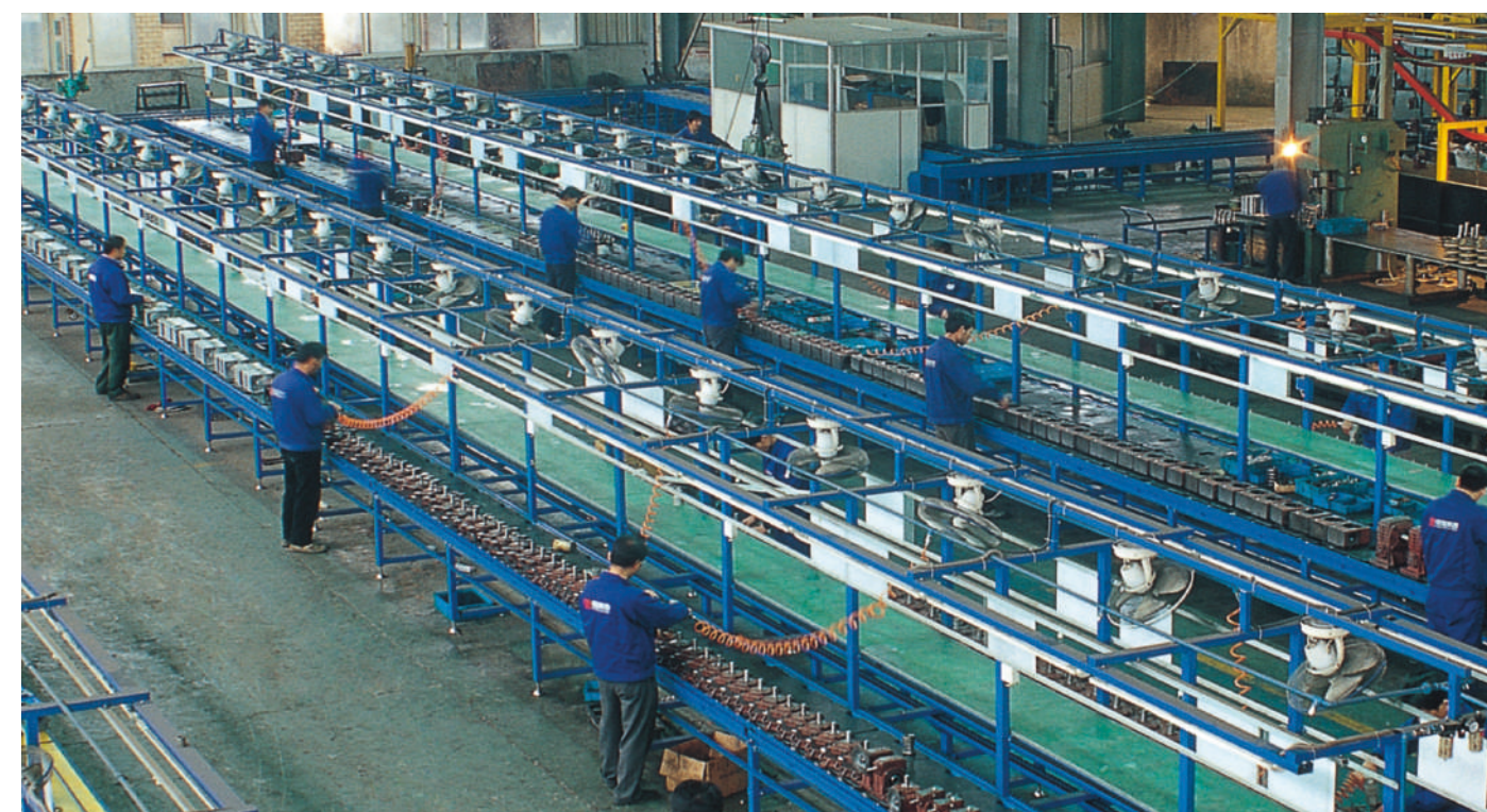
Linea assemblaggio riduttori Gear units assembly line
