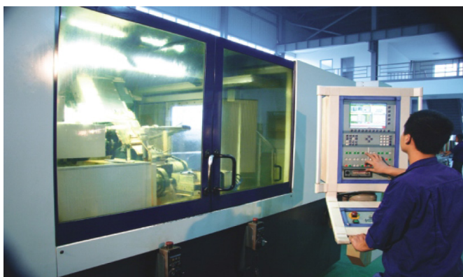
Rettifica vite senza fine - Worm screw grinding
