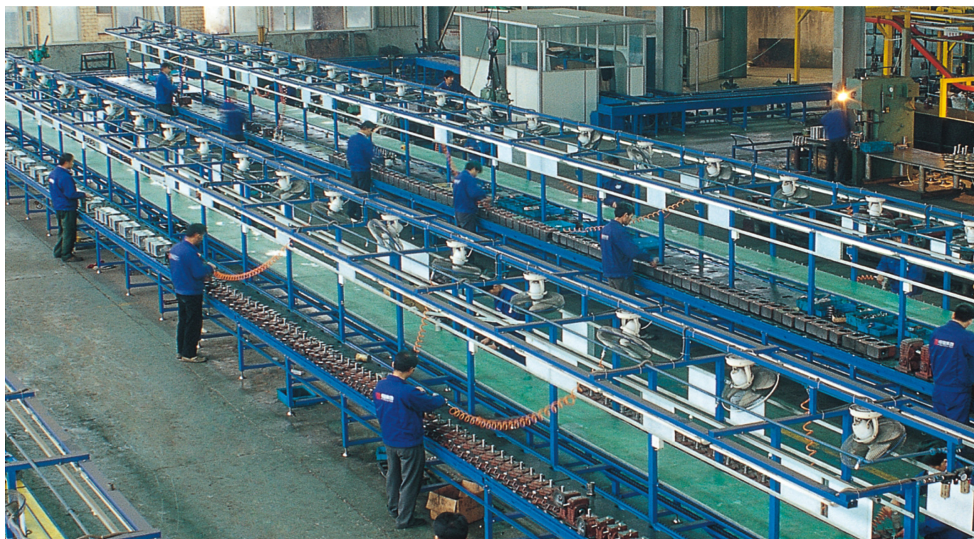
Linea assemblaggio riduttori - Gear unit assembly line
